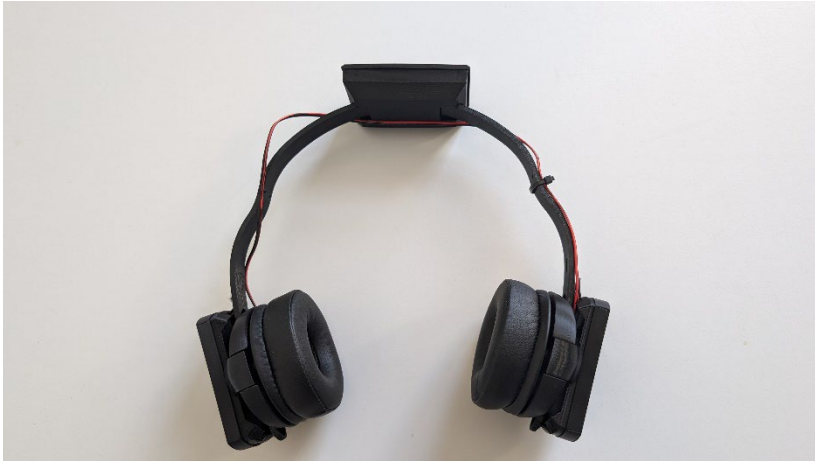
Abb. 2: Entwicklungsversion des Hörwelt-Kopfhörers, die zum großen Teil per 3D-Druck gefertigt wird
